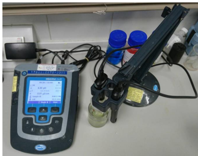
ภาพที่ 3.94 EC-meter สำหรับวัดค่าพีเอช ค่าการนำไฟฟ้า และอุณหภูมิ วัสดุอุปกรณ์ในการเก็บข้อมูลทางภูมิศาสตร์
