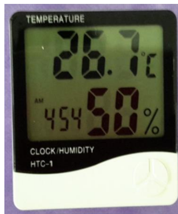
ภาพที่ 3.93 ไฮโกร - เทอร์มิเตอร์ อุปกรณ์ในการเก็บข้อมูลทางภูมิศาสตร์
